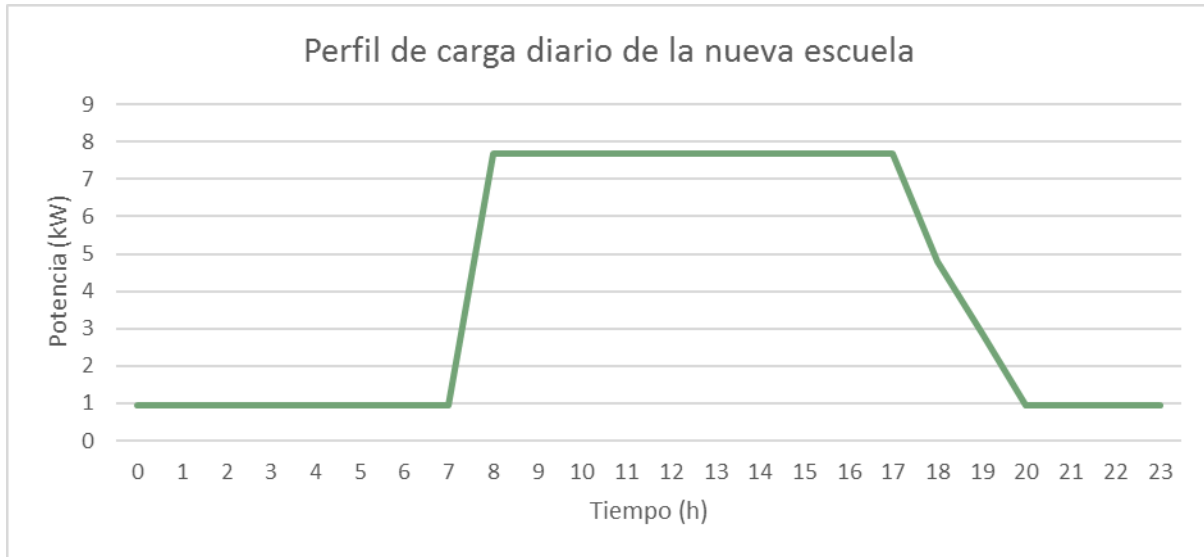
Ilustración 21: Perfil de carga diario estimado de la nueva escuela pública en San Antonio de Palé
